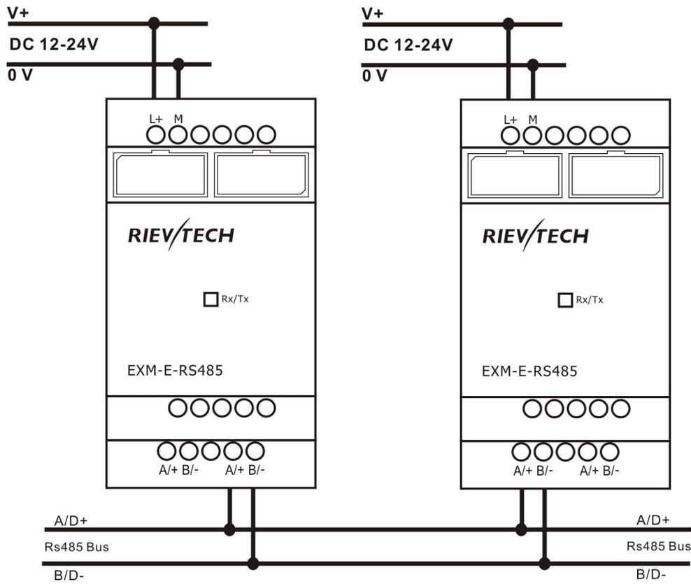
带隔离的 RS485 转换器，用来将 EXM 主机引出标准的 RS485 A,B 接线端子。通讯协议是 MODBUS RTU/ASCII.
